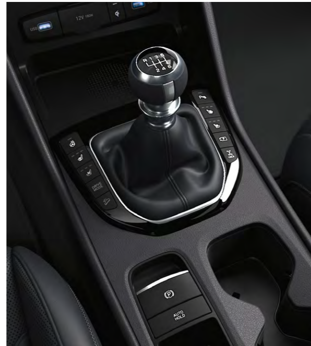
6-τάχυτο κιβώτιο iMT (Intelligent Manual Transmission).
